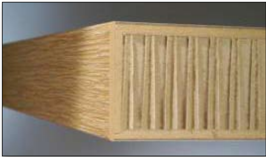
Figure 6 : Application directe d'une bande de chant sur un panneau léger à âme en papier alvéolé expansé possédant des couches de surface de panneau de particules de 8 mm ( www.doellken-kv.de ).
