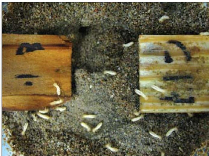
Figure 6 : Essai portant sur le choix des termites. Les termites n'ont manifesté aucune préférence entre le bois non traité et le bois traité thermiquement.
