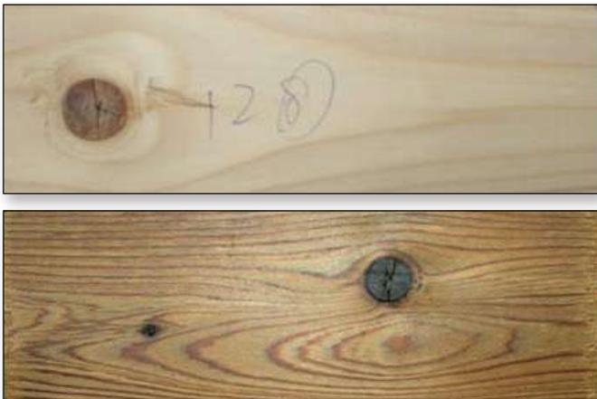
Figure 1 : Changement de la couleur après un traitement oléothermique de 2 heures dans de l'huile de soja à 220 °C.
