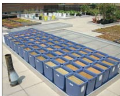
Figure 1 : Installation de vieillissement naturel
