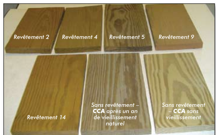
Figure 3 : Comparaison de la performance de revêtements sur du pin traité à l'ACQ et au CCA après 12 mois d'exposition à un vieillissement naturel
